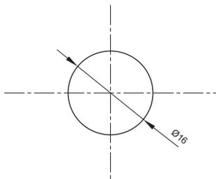
Perçage par mèche plate à bois Ø16 mm
