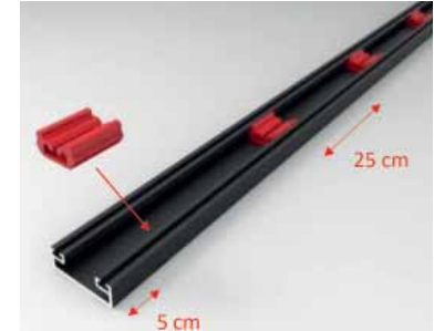
Positie van de bevestigingsclips voor het glas in de sleuven
