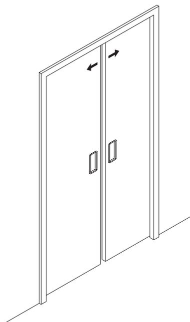
**Ferrure permettant l'ouverture simultanée de 2 portes en jusqu'à 80 kg par vantail.**
