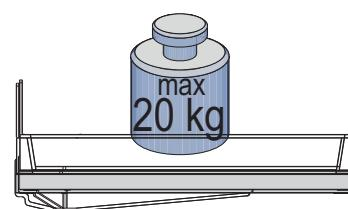
$$+ \begin{matrix} \text{max} \\ 20 \text{ kg} \end{matrix} = \Sigma = \text{max } 120 \text{ kg}$$
