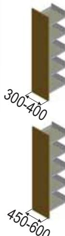
$$+ \begin{matrix} \text{max} \\ 20 \text{ kg} \end{matrix} = \Sigma = \text{max } 130 \text{ kg}$$
