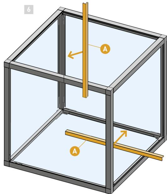
9 Dans la zone ouverte qui est destinée pour la porte vitrée, le profil à clipser PRO18187NO est utilisé. En raison de sa plus grande largeur, il complètement couvre le profil de cadre dans la zone où aucun panneau de verre n'est installé.
