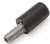
**1** Le jeu de la butée pour porte vitrée se compose d'un capuchon plastique et d'un vis sans tête M4 x 16 mm montée à la position dans le profil. A cet effet, un carottage de 3,3 mm est tout d'abord percé dans le profil, suivi par le perçage d'un filetage M4. La préparation des profils est idéalement réalisés après la planification et avant l'assemblage de la vitrine. Ensuite, la vis sans tête est serrée et couverte par le capu-chon plastique y associé.
