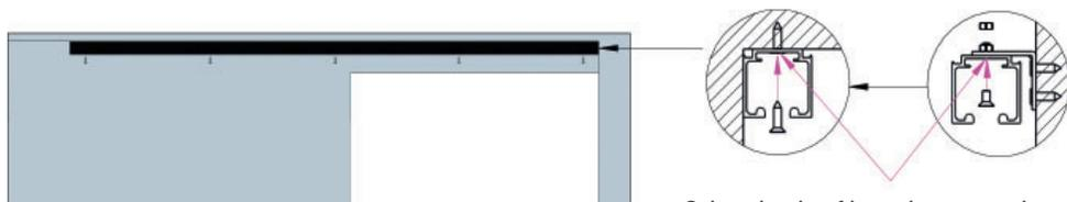
Schraubenkopf komplett versenken, um den ungehinderten Lauf des Auslösers zu gewährleisten
