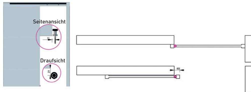
Für eine komplette Öffnung der Tür, den unteren Teil des Griffprofils ausklinken:
