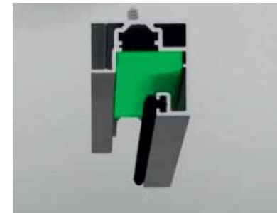
Position der Montageklötze
