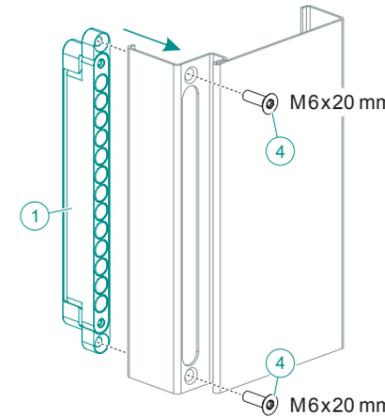
**DE** Den Schließmagneten ① rückseitig ansetzen und mit den 2 Schrauben ④ an der Zarge befestigen (8 Nm).
