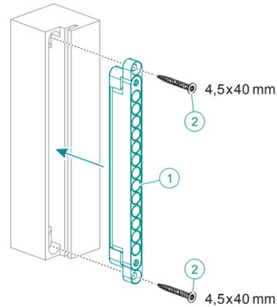
**DE** Den Schließmagneten ① in die Zarge einsetzen, die Zarge vorbohren und den Schließmagneten mit den 2 Schrauben ② befestigen.
