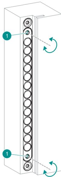
**Verstellung der Schließkraft / Adjusting the closing force / Réglage de la force de fermeture / Ajuste de la fuerza de cierre**
