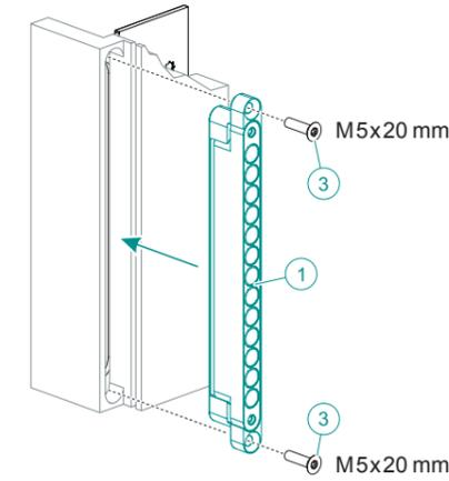
**DE** Zur Stabilisierung rückseitig die Befestigungsplatte (KC 50 FZ) verschrauben. Den Schließmagneten mit den 2 Schrauben ③ an der Befestigungsplatte befestigen (8 Nm).
